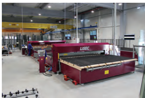
Robot presă pentru umplerea cu gaz argon și închiderea pachetului de geam izolant
